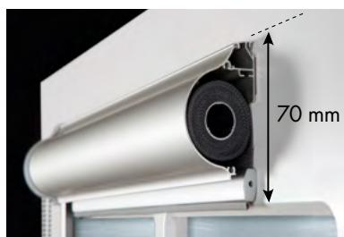
Une hauteur **minimum de 70 mm** est nécessaire au-dessus de la moulure (surface plane), afin que le coffre ne soit pas visible du derrière de la porte vitrée/ fenêtre.
