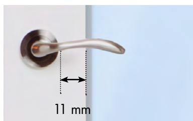
Espace **minimal de 11 mm** entre la poignée et le début de la moulure intérieure (à condition qu'il s'agisse d'une surface plane).
