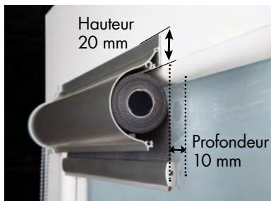
Installer au **minimum à 10 mm de profondeur** par rapport à la moulure intérieure.
